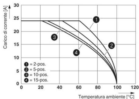
La figura illustra la curva di derating del morsetto UT 2,5/ 1P... in combinazione con i connettori UPVB 2,5
