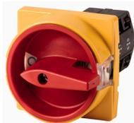
**sezionatore ausiliario, TM, 10 A, da incasso, Contatti: 4, Funzione di arresto d'emergenza, con maniglia rotativa rossa e anello di blocco giallo, lucchettabile in posizione 0**
