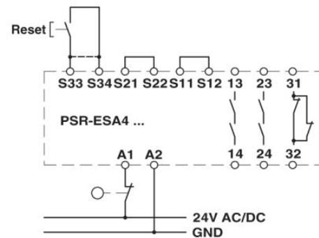
Controllo finecorsa ripari con singolo canale di comando e start automatico, indicato fino a categoria di sicurezza 2. (EN 954-1)
