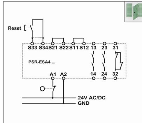
Controllo finecorsa ripari con singolo canale di comando e start automatico, indicato fino a categoria di sicurezza 2. (EN 954-1)
