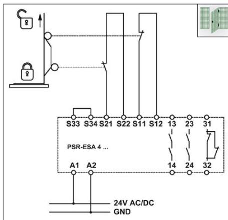
Controllo finecorsa ripari con doppio canale di comando, localizzazione cortocircuiti trasversali e start automatico. Indicato fino alla categoria di sicurezza 4 (EN 954-1).
