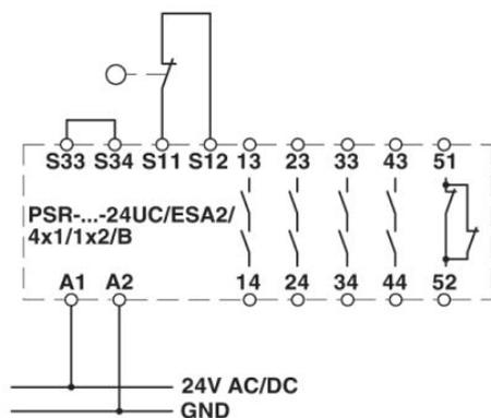
Controllo fincorsa ripari con singolo canale di comando e con start automatico. Indicato fino alla categoria di sicurezza 2 (EN 954-1).
