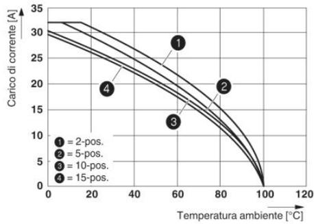
La figura illustra la curva di derating del morsetto ST 4... in combinazione con i connettori SP 4
