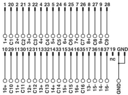
Schema di collegamento VIP-3/.../D37SUB/M/HW/C300
