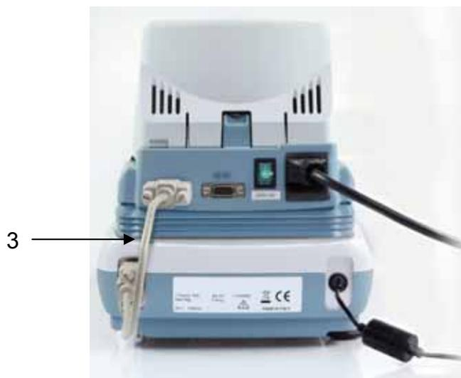
Lo strumento può essere collegato solo alla presa con spina del filo di protezione (PE), installato conformemente alle norme vigenti. La protezione può rimanere compromessa per causa di uso di prolunga senza il filo di protezione. Nel caso di alimentazione dalla rete senza la spina di sicurezza, uno specialista deve creare protezione equivalente, conforme alle disposizioni legali vigenti in materia degli impianti.
