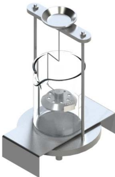
Fig.: Kit per determinazione di densità KERN YDB-01 con cestello immersibile per corpi solidi galleggianti.
