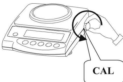
La calibrazione automatica è in corso. Compare il messaggio lampeggiante **[CAL.on]**.
