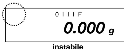
Quando sul display compare il segnale di stabilità [o] la bilancia si trova in condizioni di stabilità. Quando le condizioni sono instabile il segnale [o] scompare. Condizioni ambientali stabili possono essere ottenute utilizzando un frangivento (per il montaggio vedere cap. 5.2.4)
