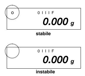
Quando sul display compare il segnale di stabilità [o] la bilancia si trova in condizioni di stabilità. Quando le condizioni sono instabile il segnale [o] scompare. Condizioni ambientali stabili possono essere ottenute utilizzando un frangivento (per il montaggio vedere cap. 5.2.4)
