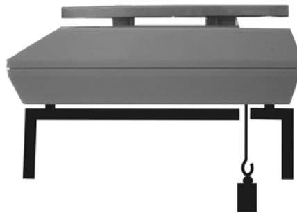
Fig. 1: Preparazione della bilancia per pesature a ponte
