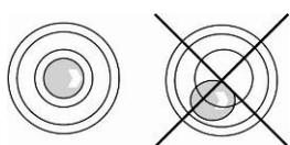
Mettere in piano la bilancia mediante i piedini regolabili con viti; la bolla d'aria della livella deve trovarsi dentro la zona segnata.
