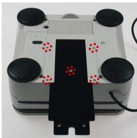
Per lo smontaggio del lamierino di montaggio svitare le viti segnate in rosso. Successivamente è possibile collocare il display separatamente.
