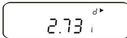
Si visualizza la densità del campione tramite il simbolo ► destra sopra.
