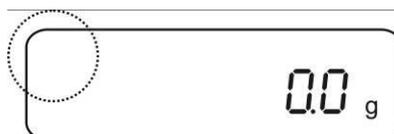
Ad indicatore visualizzato, [o] la bilancia si trova in condizione di stabilità; In condizioni di instabilità, l'indicazione [o] sparisce.
