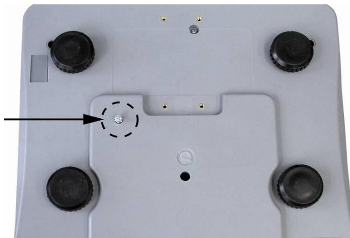
Per togliere le sicurezze utilizzate per il trasporto svitare la vite [1], avvitata a tal fine, girandola in senso antiorario.
