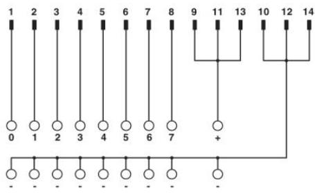
Schema di collegamento FLKM 14/8M/PLC
