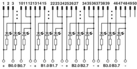
Schema di collegamento UM 45-FLK50/LA/PLC
