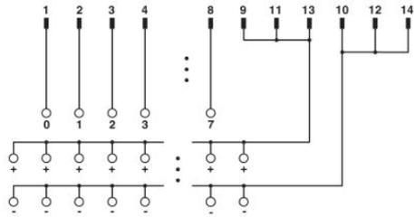
Schema di collegamento FLKMS 14/8IM/PLC
