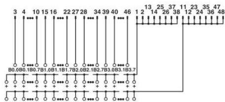
Schema di collegamento FLKMS 50/32IM/PLC, ...50/32IM/
