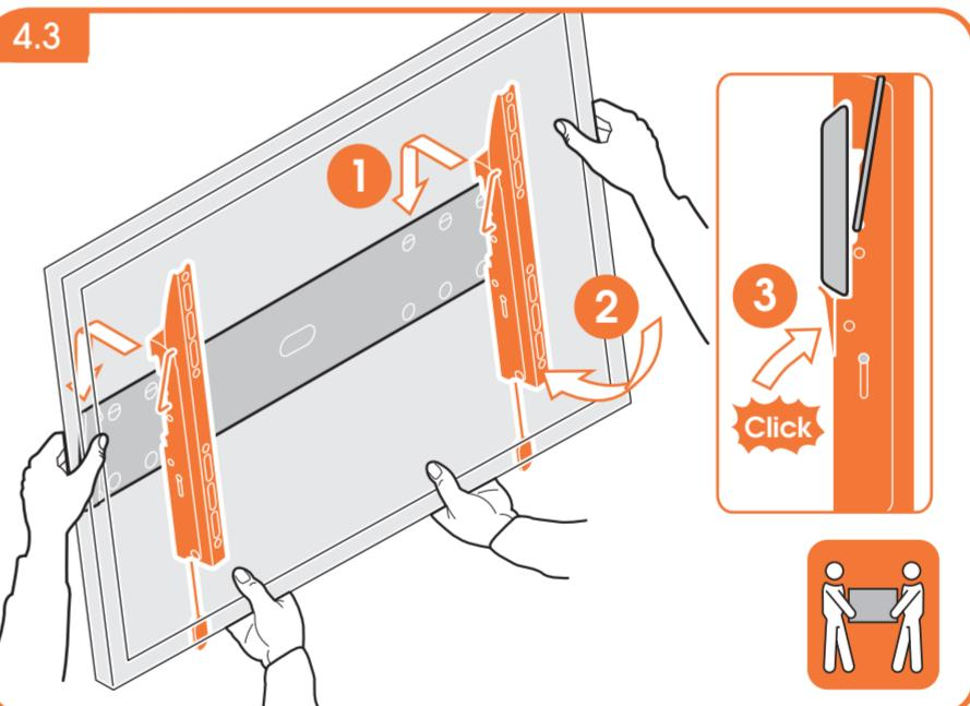
RU настенное крепление для светодиодных и ЖК-панелей с возможностью наклона
