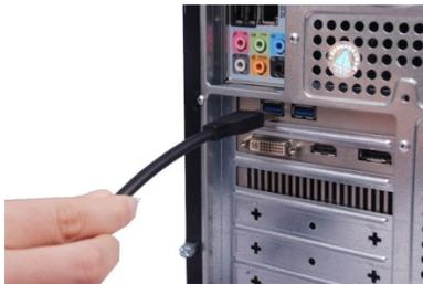
3. Abbiate l'alimentatore esterno pronto per connetterlo con il CAVO DA USB 3.0. A SATA E IDE ed accendetelo. Rileverà l'Hard Disk SATA.
