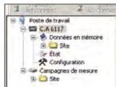
► Il menu visualizza la struttura ad albero dei dati presenti nel controllore e le sessioni di misurazione chiaramente identificate (cliente, luogo, tipo di misurazione e così via).
