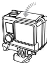
La custodia per la videocamera HERO3 ha in dotazione due tipi di sportello posteriore — Skeleton (non impermeabile) e Standard (impermeabile).
