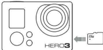
1. Introdurre la scheda di memoria nell'apposita slot con l'etichetta rivolta verso la parte anteriore della videocamera.
