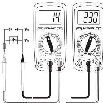
➔ Non appena compare un meno „-“ davanti al valore misurato per la tensione continua, la tensione misurata è negativa (oppure i cavi di misura sono invertiti).
