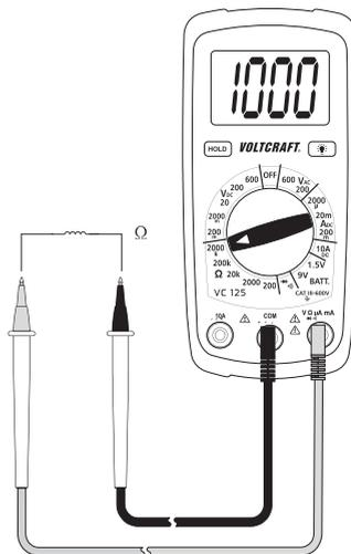
➔ Quando si esegue una misurazione della resistenza, accertarsi che i punti toccati con i puntali per effettuare la misurazione non presentino tracce di sporcizia, olio, vernice per saldatura o sostanze simili. Il risultato della misurazione potrebbe essere altrimenti alterato.
