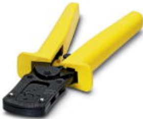
Pinza a crimpare per contatti a crimpare stampati RC Ø 1 mm per sezione fili 0,08 mm 2 ... 0,56 mm 2
