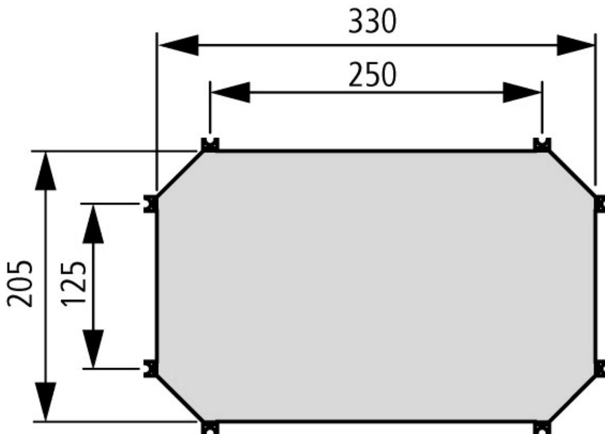
Piastra di montaggio M3-...: spessore 3 mm
