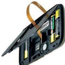
Rimettere il coperchio del vano batterie; il cavo in gomma sarà inserito in una piccola apertura in modo da passare attraverso il coperchio.
