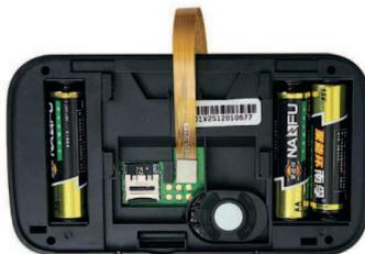
Collegare il cavo in gomma premendolo sulla connessione, si sentirà un "Clic" una volta fissato al circuito stampato. Assicurarsi che il cavo sia posizionato correttamente come mostrato nell'immagine.
