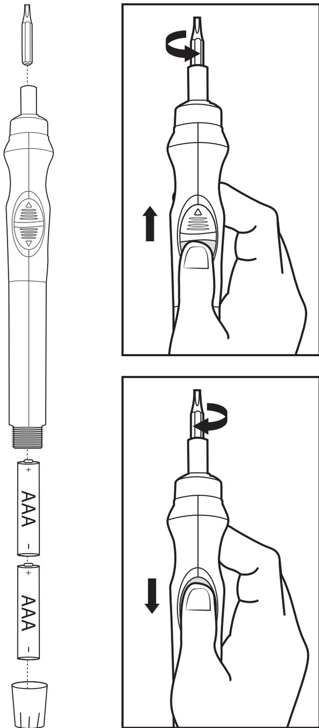
→ Sostituire le batterie non appena si verifica un'evidente riduzione della velocità di rotazione.
