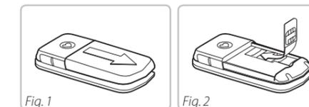
**Fig. 1:** rimuovere il coperchio della batteria
