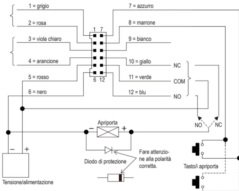
In base al tipo di apriporta dovrà essere utilizzato il connettore "NO" o "NC" della serratura a codice ("Fail-Secure" => "NO", "Fail-Safe" => "NC").
