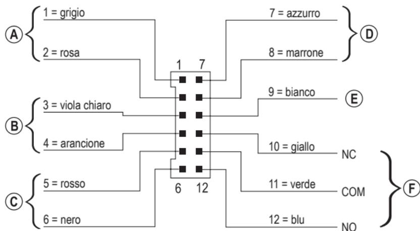
Il cavo di collegamento fornito con il connettore a 12 poli è dotato di 12 fili singoli con codifica a colori. Di seguito sono riportate le assegnazioni.
