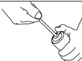
Tirando l'asta di spinta, azionare il fermo e spingere di nuovo l'asta nel tubo.
