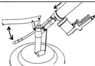
Sistemare l'ingrassatore con il nipplo di riempimento sulla valvola di riempimento della pompa per riempire l'ingrassatore e trattenerlo esercitando una leggera contropressione.
