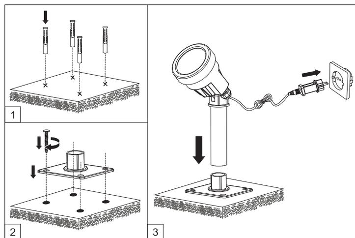
1. Utilizzare la piastra di montaggio come sagoma per contrassegnare i quattro punti di fissaggio sulla base.
