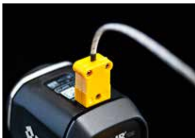
Il modello TG56 dispone di ingresso per una termocoppia tipo K
