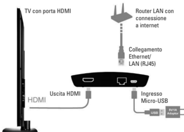
Il cavo HDMI mostrato nella configurazione, il cavo USB => cavo micro USB e l'alimentatore USB fanno parte della fornitura.
