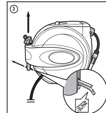
1. Premere insieme le estremità del perno in metallo (1) con una pinza, estrarre il perno metallico dal tubo di supporto (2). Rimuovere dall'alto il tubo di supporto.
