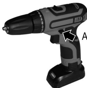
In posizione centrale, il commutatore del senso di rotazione blocca l'interruttore di accensione e quindi il motore dell'avvitatore a batteria.
