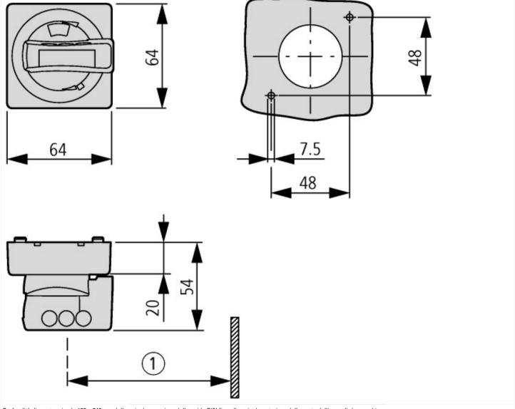
Profondità di montaggio: da 125 a 240 mm dallo spigolo superiore della guida DIN fino allo spigolo anteriore della porta dell'armadio/coperchio
