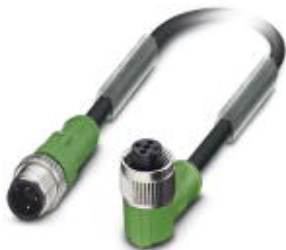
Cavo sensore-attuatore, 3-poli, PUR senza alogenati, grigio-nero RAL 7021, Maschio diritto M12, codifica A, su Femmina angolato M12, codifica A, Lungh. cavo: 0,6 m
