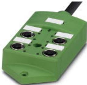
Box sensore/attuatore, Applicazione: Standard, Collegamento: Connettore femmina M12-SPEEDCON Metallo, Numero degli slot: 4, N. poli: 4, Codifica: A - Standard, Piedinatura slot: singolo, Segnalazione stato: sì, pnp; Connessione linea principale: Attacco fisso 180°, PUR/PVC, Lunghezza cavo: 5 m, Schermatura: no
