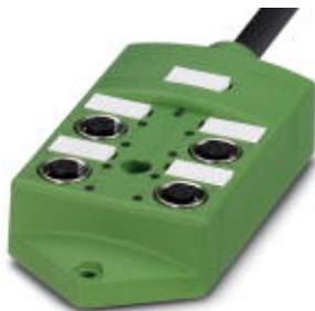
Box sensore/attuatore, Applicazione: Standard, Collegamento: Connettore femmina M12-SPEEDCON Metallo, Numero degli slot: 4, N. poli: 5, Codifica: A - Standard, Piedinatura slot: doppi, Segnalazione stato: sì, pnp; Connessione linea principale: Attacco fisso 180°, PUR/PVC, Lunghezza cavo: 10 m, Schermatura: no
