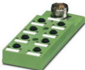
Box sensore/attuatore, Applicazione: Standard, Collegamento: Connettore femmina M12 Plastica, Numero degli slot: 8, N. poli: 5, Codifica: A - Standard, Piedinatura slot: doppi, Segnalazione stato: sì, pnp; Connessione linea principale: Connessione M23 90°, Schermatura: no
