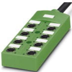
Box sensore/attuatore, Applicazione: Standard, Collegamento: Connnettore femmina M12-SPEEDCON Metallo, Numero degli slot: 8, N. poli: 5, Codifica: A - Standard, Piedinatura slot: doppi, Segnalazione stato: sì, pnp; Connessione linea principale: Attacco fisso 180°, PUR/PVC, Lunghezza cavo: 5 m, Schermatura: no
