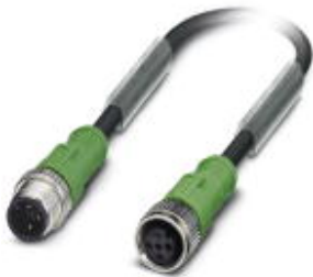
Cavo sensore-attuatore, 3-poli, PUR senza alogenati, grigio-nero RAL 7021, Maschio diritto M12, codifica A, su Femmina diritto M12, codifica A, Lungh. cavo: 0,3 m
