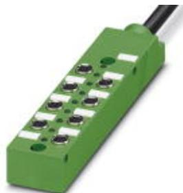
Box sensore/attuatore, Applicazione: Standard, Collegamento: Connettore femmina M8 Metallo, Numero degli slot: 8, N. poli: 3, Codifica: A - Standard, Piedinatura slot: singolo, Segnalazione stato: si, pnp; Connessione linea principale: Attacco fisso 180°, PUR/PVC, Lunghezza cavo: 5 m, Schermatura: no
