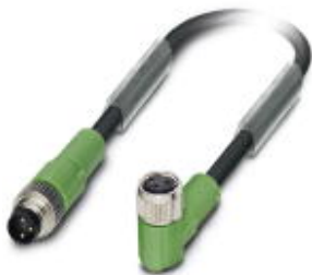
Cavo sensore-attuatore, 3-poli, PUR senza alogenati, grigio-nero RAL 7021, Maschio diritto M8, su Femmina angolato M8, Lungh. cavo: 0,3 m
