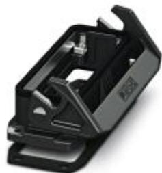
Custodia da incasso HEAVYCON EVO in plastica, B24, con bloccaggio longitudinale, altezza 30,5 mm, con guarnizione piatta
