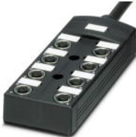
Box sensore/attuatore, Applicazione: Esterni, Collegamento: Connettore femmina M12 Metallo, Numero degli slot: 8, N. poli: 5, Codifica: A - Standard, Piedinatura slot: doppi, Segnalazione stato: No, Universale; Connessione linea principale: Attacco fisso 180°, PUR/PVC, Lunghezza cavo: 10 m, Schermatura: no
