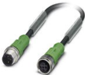
Cavo sensore-attuatore, 3-poli, PUR senza alogenati, grigio-nero RAL 7021, Maschio diritto M12, codifica A, su Femmina diritto M12, codifica A, Lungh. cavo: 1,5 m
