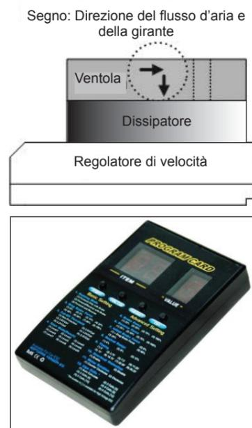
**Collegare l'ESC alla scheda di programma LED tramite la porta di programmazione.**
