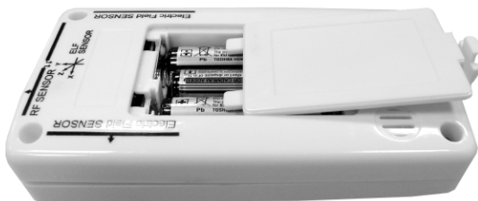
Figura 5 installazione delle batterie
